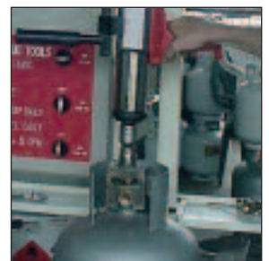
Ventilmontage und -demontage bei Gasflaschen mit dem PT1500
