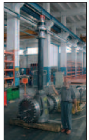
Kugelventilbetätigung mit dem PT13
