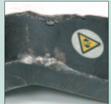
Anzeichen für unzureichende Abstützung sind an diesem beschädigten Reaktionsfuß erkennbar. Die Reaktionskraft wurde am falschen Punkt des Reaktionsfußes abgenommen und Schartenbildung verweist auf Schlupf des Fußes am Reaktionspunkt.
