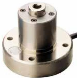
Der Statische Drehmomentsensor mit feststehender Welle eignet sich hervorragend zum Prüfen von mechanischen Drehmomentschlüsseln und -schraubendrehern. Unter Einsatz eines passenden Schraubfallsimulators (Joint Kit) lassen sich aber auch kontinuierlich drehende Schrauber wiederholgenau prüfen (nichtabschaltend).
